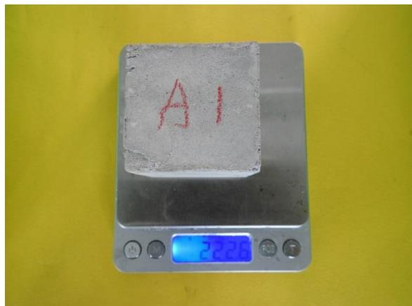
圖 8-2 固定一段時間，逐一測量試體重量
