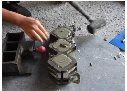
圖 4-6 敲擊填滿及排除氣泡
