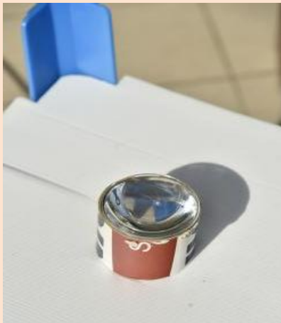
圖 26 凸透鏡連接光纖並固定在裝置上
