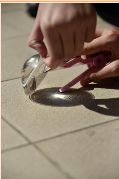
圖 25 觀察並調整適當觀察並以圓規測量焦距
