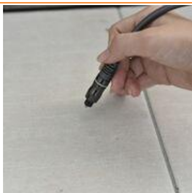
圖 33-1 陽光直接照射光纖： 只有 微量 光線滲出〈對照組〉
