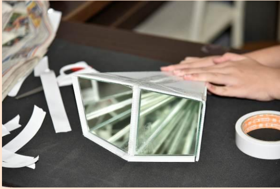
圖 24 陽光收集器製作過程及步驟
