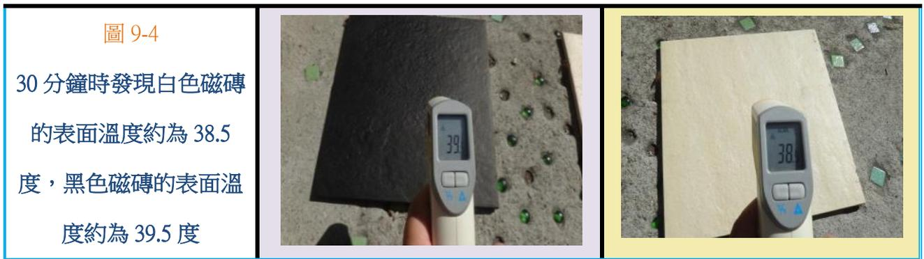
圖 9 探討每分鐘白色磁磚和黑色瓷磚溫度之變化
