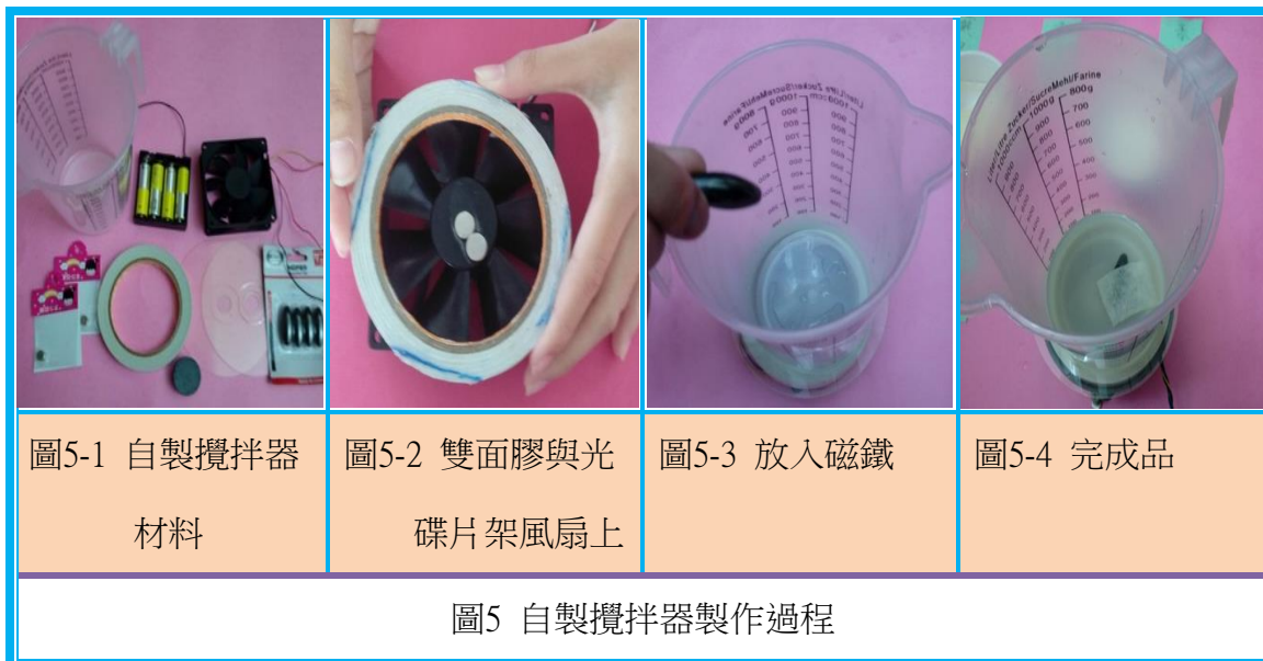
自製攪拌器製作過程 圖 5
