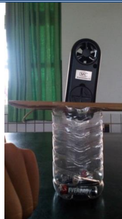
圖 45 但因風速固定器過輕，因此在寶特瓶內放電池
