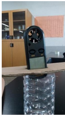
圖 44 風速計固定器完成圖
